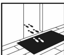
Ausreichend dimensionierte textile Sauberlaufzonen von mindestens 4 bis 6 laufenden Metern können den Schmutzeintrag im Objekt um bis zu 80% reduzieren und somit den Nutzwert des Belages und die Reinigungskosten erheblich beeinflussen.
